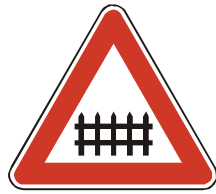
A 25 Železničné priecestie so závorami
