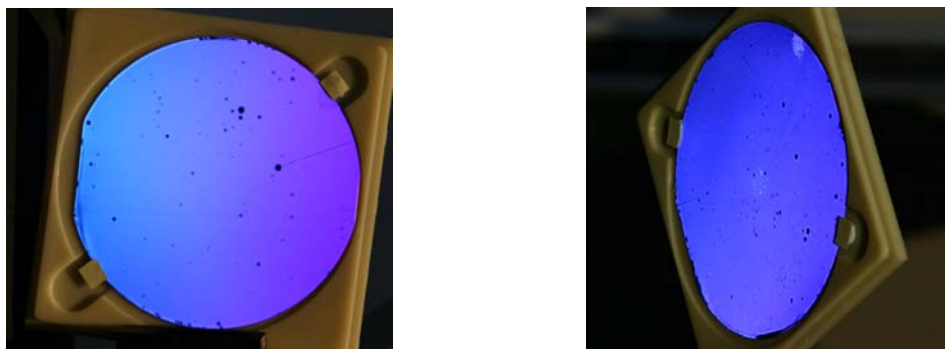
Obr. 1 a, b Vizualizácia periodickej štruktúry na povrchu substrátov pomocou difrakcie
