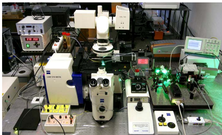
Snímka konfokálneho laserového skenovacieho mikroskopu LSM 510 META v kombinácii so systémom časovo a spektrálne rozlíšenej detekcie fluorescence budenej pulznými piko- a femto-sekundovými lasermi.
