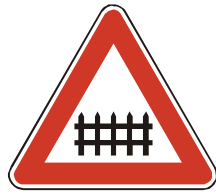
A 25 Železničné priecestie so závorami
