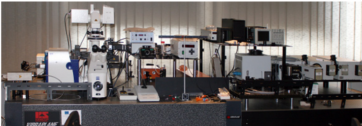
Obr. 15. Celkový pohľad na vybudované pracovisko. Mikroskop Zeiss LSM 510 META NLO (vľavo), excitačný femtosekundový laserový systém (v strede), trojitý spektrograf Acton Research (vpravo).
