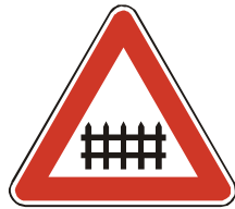
A 25 Železničné priecestie so závorami
